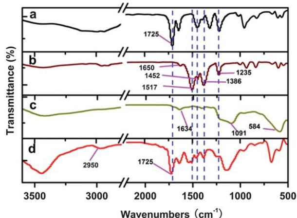
Fig. 2 FTIR spectra of MMA (a), MMA-Pb(II) (b),  $\text{Fe}_3\text{O}_4@\text{SiO}_2@\text{MPS}$  (c),  $\text{Fe}_3\text{O}_4@\text{SiO}_2@\text{IIPs}$  (d).
