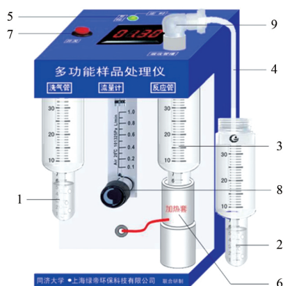
1—洗气管;2—吸收管;3—反应管;4—导气管;5—时间设置按钮; 6—加热器;7—气泵开关;8—气体流量计;9—加料口
