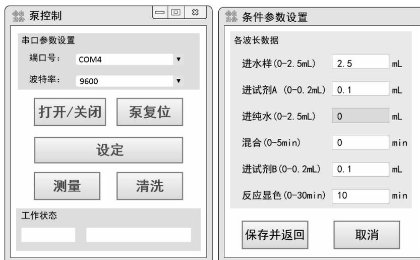
图2 泵控制界面和条件参数设置窗口
